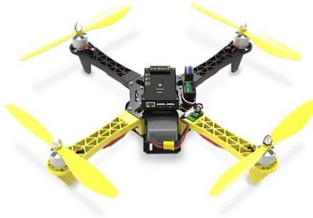
Figura 7: Braços originais do drone a serem redesenhados
